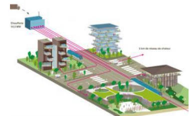
Centrale biomasse à l'échelle d'un quartier
